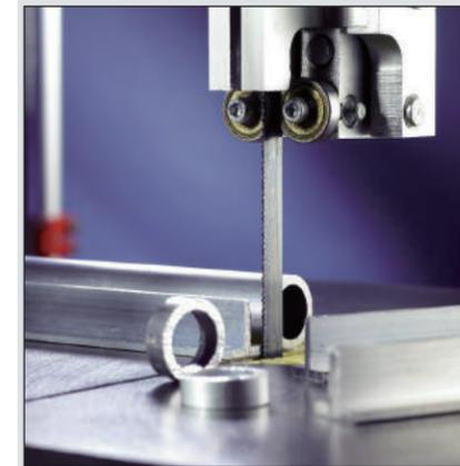
提供低合金和有色金属材料切割的低成本解决方案。**柔性锯条是切割铝、黄铜、青铜、铜和其他软金属的理想选择。**可提供的宽度为 1.6 毫米至 50 毫米。刚性锯条有增加其弯曲强度的较硬衬底物，可促进直线切割，并能抗摇摆及刮伤。可提供的宽度为 6 毫米至 32 毫米。
