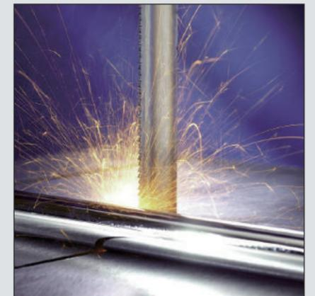
摩擦带锯采用高硅铝合金制造，适用于高速摩擦切割应用领域，如以宽度为 25 毫米以下的带锯切割有色金属和难于切割的材料可提供的宽度为 20 毫米至 25 毫米。
